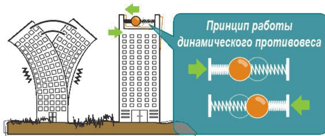
Принцип работы динамического противовеса в системе AVT
